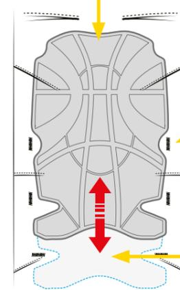
Six points d'arrêt maintiennent la genouillère en place, deux pour la hauteur et quatre pour le centrage.
