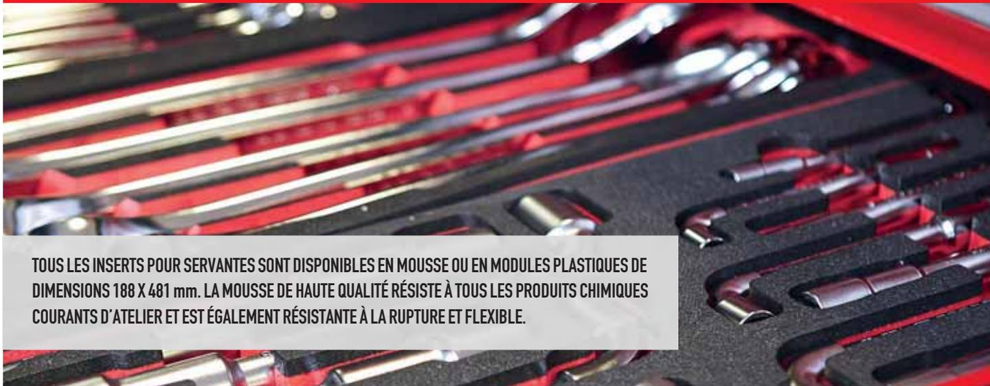
TOUS LES INSERTS POUR SERVANTES SONT DISPONIBLES EN MOUSSE OU EN MODULES PLASTIQUES DE DIMENSIONS 188 X 481 mm. LA MOUSSE DE HAUTE QUALITÉ RÉSISTE À TOUS LES PRODUITS CHIMIQUES COURANTS D'ATELIER ET EST ÉGALEMENT RÉSISTANTE À LA RUPTURE ET FLEXIBLE.
